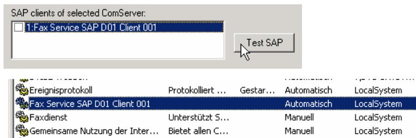
Ob die Verbindung zum R/3-System korrekt eingerichtet ist, lässt sich über die Test SAP-Schaltfläche ermitteln. Achtung: dazu muß der entsprechende Benutzer im R/3-System schon eingerichtet worden sein. Im ersten Schritt wird überprüft, ob der Host mit PING erreichbar ist. Sollte die Namensauflösung nicht korrekt arbeiten, wird die in der Folge eingegebene IP-Adresse in die lokale HOSTS-Datei eingetragen.
