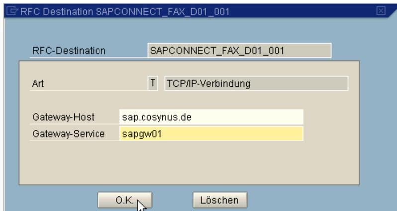
Die Eingaben sind mit O.K. zu bestätigen. Die Konfiguration wird mit Strg+S gespeichert. Danach kann bei gestarteten ComServer-Diensten die Verbindung mit F8 getestet werden.
